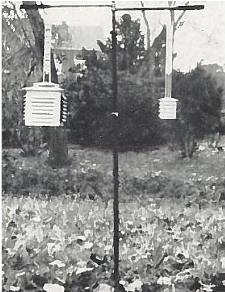
Figuur 10 De proefopstelling van Kramer met links het vinydur hutje
